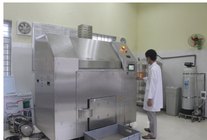
TTYT Than Uyên được đầu tư xử lý rác thải bằng công nghệ hấp ứot kết hợp nghiền cắt và khử trùng
